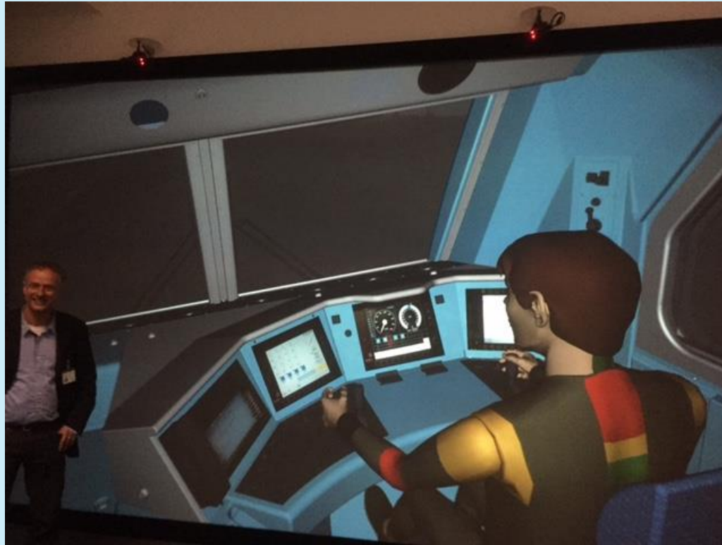
3D-Modell eines Fahrerstandes, generiert aus mit CATIA V5 erzeugten CAD-Daten
