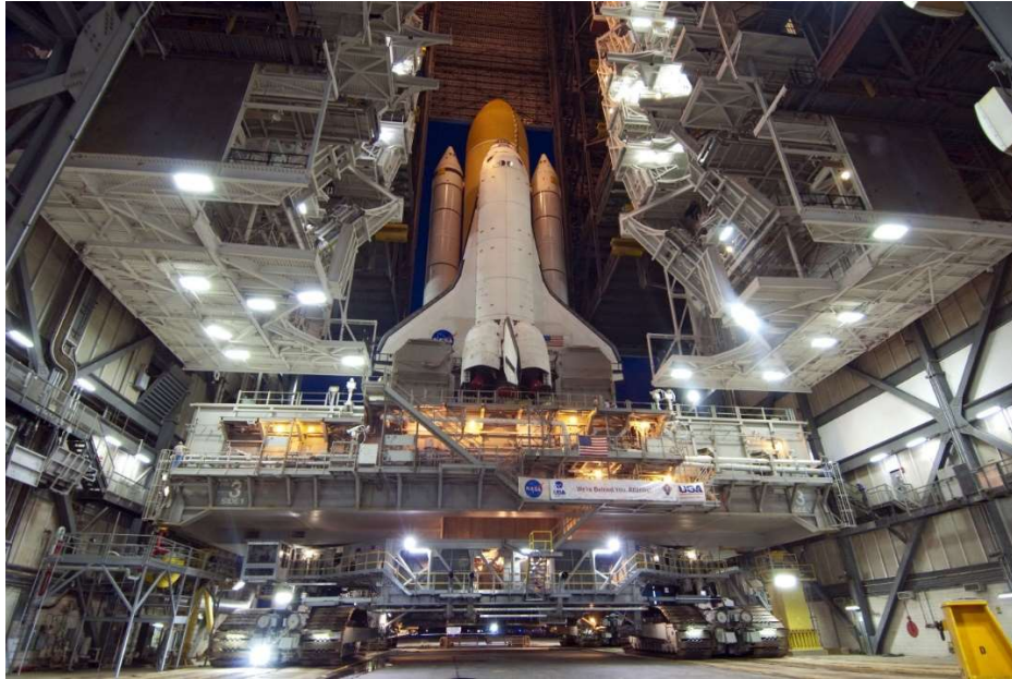
»Rollout« der Raumfähre »Atlantis« auf dem MLP mit dem Crawler Transporter aus der Highway 1 des VAB zur Startrampe 39A. (Foto: Gerhard Daum)
