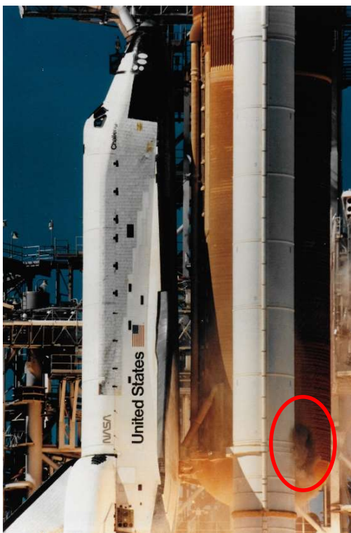
Beginn der Tragödie der Raumfähre »Challenger« am 28. Januar 1986 bei der Mission STS-51-L. In der rechten Feststoffrakete ist eine Undichtigkeit eines O-Rings durch Rauchentwicklung etwa 3 Sekunden nach dem Abheben sichtbar. (rote Markierung)
