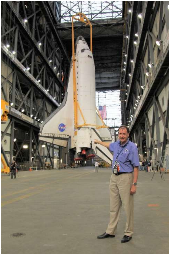
Gerhard Daum vor der Raumfähre »Atlantis« im VAB. Die Raumfähre wird mit einem 175 Tonnen Kran in die High Bay 1 gehoben um mit dem externen Tank verbunden zu werden.
