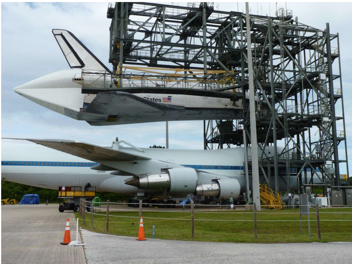
Die Raumfähre »Endeavour“ OV-105 während der Demontage vom SCA (Shuttle Carrier Aircraft) im Mate/Demate Device an der SLF (Shuttle Landing Facility) im Kennedy Space Center in Florida.
