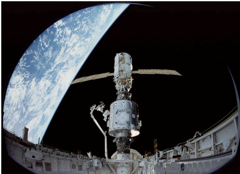
Kopplung des russischen »Sarja«-Moduls mit dem US-amerikanischen »Unity«-Modul in der Nutzlastbucht der Raumfähre »Endeavour« während der Mission STS-88 – die Geburtsstunde der ISS im Dezember 1998. (Foto: NASA)
