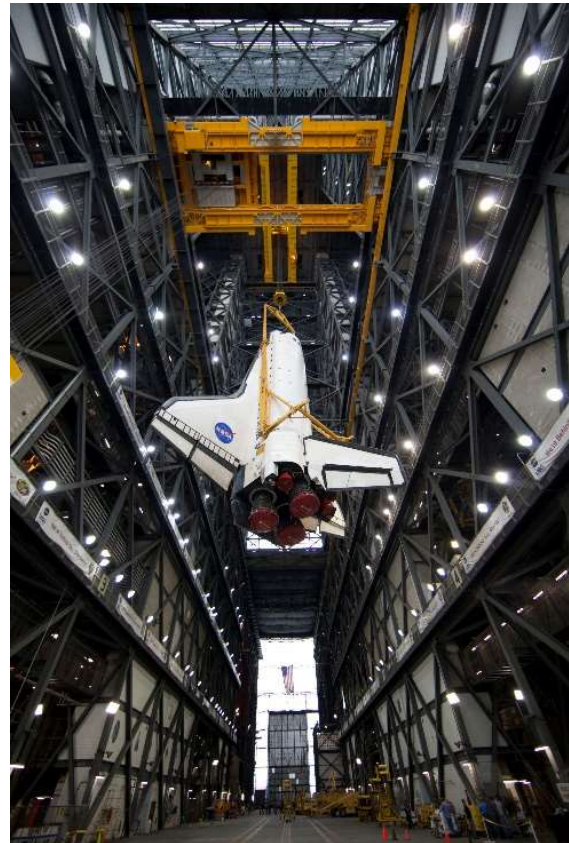
Gerhard Daum vor der Raumfähre »Atlantis« im VAB. Die Raumfähre wird mit einem 175 Tonnen Kran in die High Bay 1 gehoben um mit dem externen Tank verbunden zu werden.
