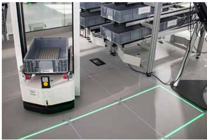
Fahrerlose Transportfahrzeuge werden vom intelligenten Fußboden gesteuert. Foto: Kathrain Graubaum
