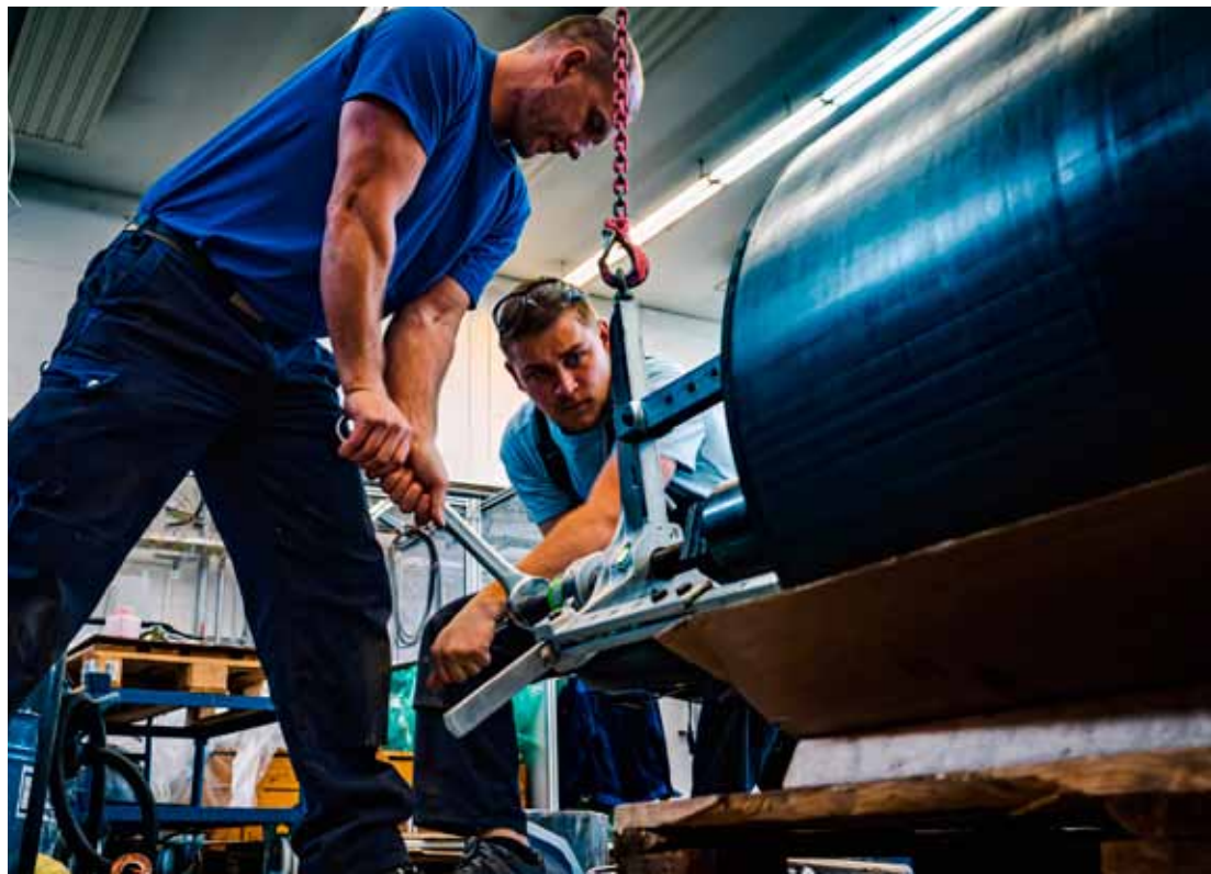
RAMME-Mitarbeiter beim Arbeiten an einem Rotor mit Permanentmagneten. Fotos (2): RAMME Electric Machines GmbH
