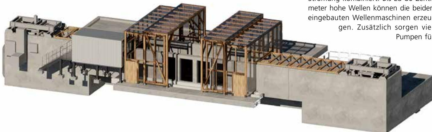
30 Meter lang, drei Meter breit und 2,50 Meter tief ist der salzwassertaugliche Wellen- und Strömungskanal.
