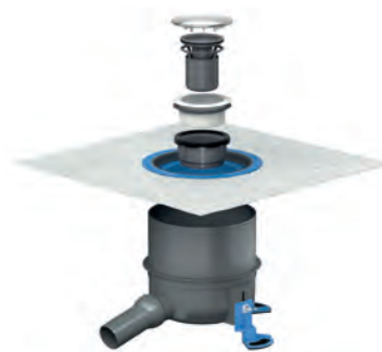
Der Duschwannenablauf ist für Mineralguss-Duschwannen mit direkter Auflage geeignet. Das elastische Flex-Element ist dabei das zentrale Bauteil des Duschwannenablaufs. Bild: Dallmer
