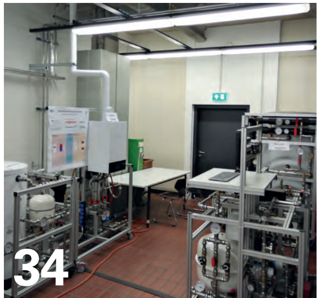
34 Forschungsprojekt „SmartAdapt“: An der Beuth Hochschule in Berlin erprobt man einen adaptiven Regelalgorithmus zur Betriebsoptimierung von Heizungsanlagen. Bild: Le, Anisits, Scheunemann
