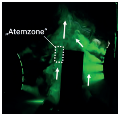
Bild 4: Visualisierung der „körpereigenen“ Auftriebsströmung am Personenemulator. Bild: Viessmann Climate Solutions SE
