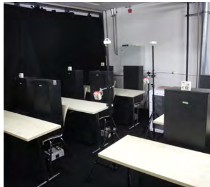
Bild 5: Positionierung der CO 2 -Sensoren im Laborversuch. Bild: Viessmann Climate Solutions SE
