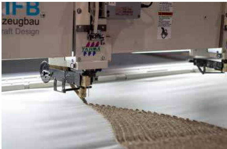
Tailored Fibre Placement: Das digital gesteuerte Stickverfahren wurde aus der Textil- und Flugzeugbauindustrie übernommen. Durch die kontrollierte Anordnung der Langfasern lassen sich deren Zugfestigkeitseigenschaften optimal ausnutzen
