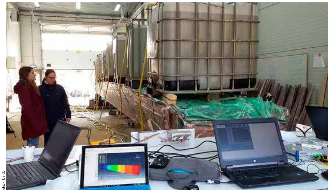
Belastungstest: Für die Fußgängerbrücke auf dem Campus der TU Eindhoven kamen Hanf- und Flachfasern zum Einsatz, die mit einem Epoxidharz kombiniert wurden, dessen Bioanteil bei 56 % liegt
