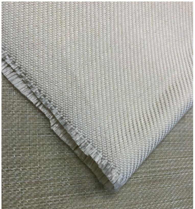
Im industriellen Maßstab hergestelltes Hybridgarngewebe und daraus hergestellter Verbundwerkstoff (Hersteller: COMFIL, Foto: ITA).
