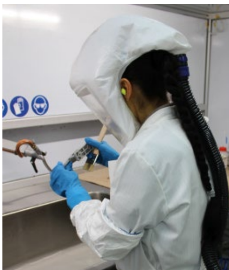
Bild 2: Auswaschen eines SLA-Bauteils (Foto: cirp GmbH)
