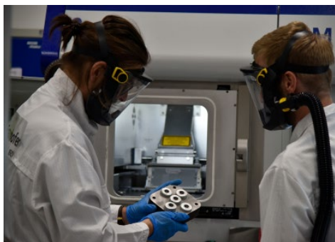
Bild 1: Ausbau eines Baujobs auf einer Laser-Strahlschmelzanlage (Foto: Fraunhofer IGCV)
