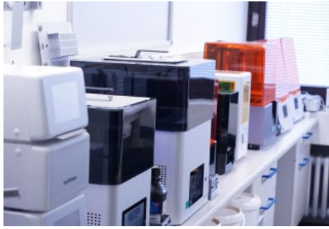
Bild 3: Druckerraum für die additive Fertigung von Bauteilen aus Harzmaterialien (Foto: A. Xepapadeas, Universitätsklinikum Tübingen)
